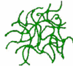
Hình 1.3 Sự phát triển cấu trúc tinh thể trong điều kiện xúc tác axit
