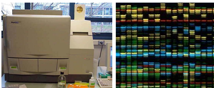
Hình 5.14. Máy phân tích trình tự nucleotide tự động và hình ảnh điện di các băng DNA phát huỳnh quang quan sát được trên computer
