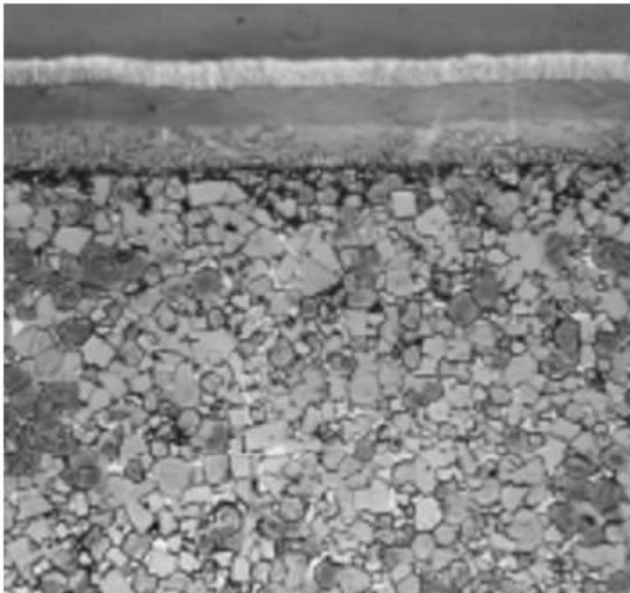
Hình 1.14. Vi cấu trúc của ống lót đa lớp với độ phóng đại 1500 lần. (Dưới sự cho phép của Kennametal Inc.)
