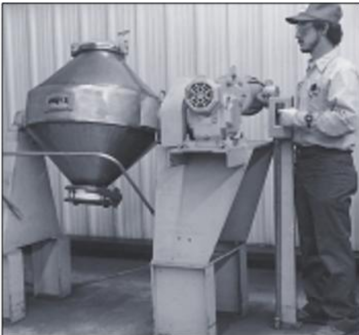
Hình 1.2. Thiết bị trộn Cacbua, được biết đến với tên gọi là máy nghiền bi được sử dụng để đảm bảo phân tán tối ưu cacbon vào vonfram. (Dưới sự cho phép của công ty sản xuất Cacbua Hoa kỳ)
