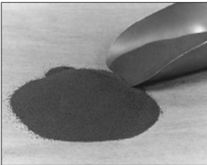
Hình 1.3. Bột cacbua vonfram hỗn hợp được sản xuất bằng cách trộn cacbua vonfram (WC) với chất kết dính coban (Co) trong quá trình nghiền bi. (Dưới sự cho phép của công ty sản xuất Cacbua Hoa kỳ)
